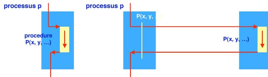
L'effet de l'appel doit être identique dans les deux situations. Cela est impossible à réaliser en présence de défaillances
