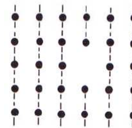
Figure 23.7 – Défauts ponctuels dans un réseau cristallin.
